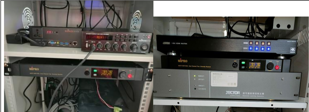
講桌設計:由資訊面板來控制電腦與麥克風音量，另接有線麥克風插孔於桌面
