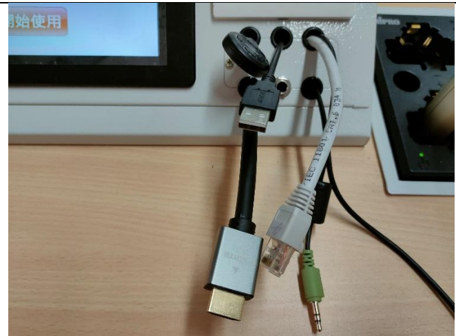
麥克風插孔與筆電接線(HDMI、USB TOUCH、網路與音源線等)
